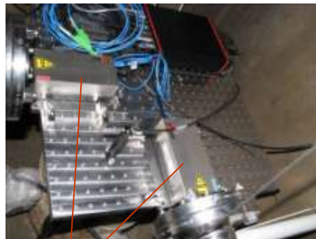
Interferometer in Edelstahlausführung mit modifizierter Optik
