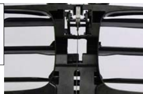
Stellantrieb Kühlluftklappe – FG-Antrieb
