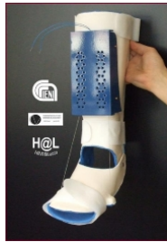
Orthese mit Nitinol-Aktor zur Unterstützung der Bewegung bei Fußhebeschwäche [2]
