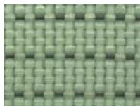
PES-Multifilament-Gewebe mit 3 eingearbeiteten FGL-Drähten
