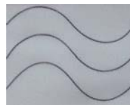
Flächengewirke mit 3 aufgestickten FGL-Drähten in Mäanderform
