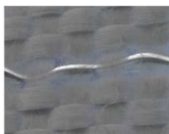
μCT-Aufnahme eines textilen Gewebes mit eingearbeitetem FGL-Draht
