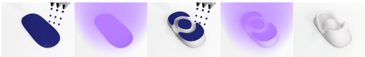
Abbildung 1: Abfolge des additiven Fertigungsprozesses beim 3D-Inkjet-Druck optischer Volumenkörper, von links nach rechts: Druck einer Schicht aus optischem Polymer, UV-Teilvernetzung der gedruckten Schicht, Drucken der folgenden Schicht, erneute UV-Teilvernetzung, aus vielen Schichten aufgebauter, komplett durchvernetzter finaler Volumenkörper
