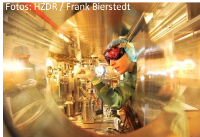
In der Target-Kammer trifft der Lichtstrahl des Hochleistungslasers auf den Elektronenstrahl des ELBE-Beschleunigers.
