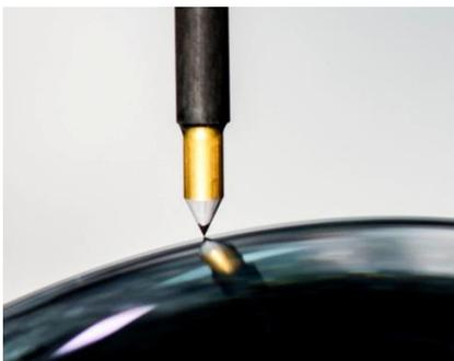
Optikfertigung für Kleinserien und Musterfertigung von 10 mm bis 2 m Durchmesser, Prozessentwicklung Schleifen, Polieren, Korrigieren, Machbarkeitsstudien in der Verknüpfung vom Design über die Fertigung in Genauigkeiten bis 10 PV je nach Geometrie und Eingangsqualität.
