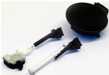
FGL-Entriegelungsmechanismus für Tankklappen: Reduktion von Bauraum und Gewicht
