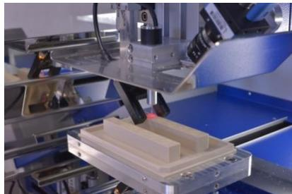
Gerät ArtCut® - standardisierte automatisierte Wundsetzung, © K. Selsam, Fraunhofer ISC
