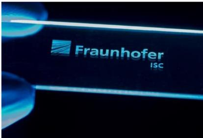
Array mit über 10.000 Mikroprismen, mit TPA in Hybridpolymer hergestellt, © K. Selsam, Fraunhofer ISC
