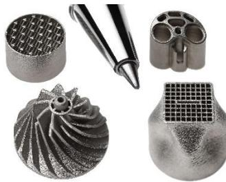
hen Schicht für Schicht metallische Mikrobauteile mit hoher Genauigkeit, sehr guter Oberflächengüte und hoher Dichte für verschiedenste Branchen und Industriezweige.
