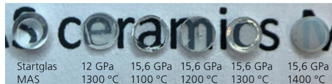
Abb. 3: Transparentkeramiken, hergestellt über die Hochdruckroute unter verschiedenen Drücken und Temperaturen, Durchmesser von ca. 3–5 mm.
