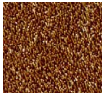
Abb. 8: AFM-Aufnahme einer geprägten »NANO-motheye«-Struktur (10 \mu\text{m} x 10 \mu\text{m} x 400 nm).
