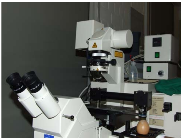
Abbildung 1: LSM 410 mit neukonstruiertem Spiegelgelenkarm für in vivo FLIM/SLIM am CAM Modell
