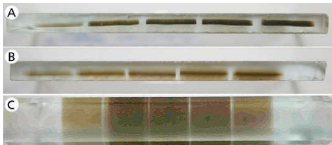
Bild 2: Seitenansicht der Kalk-Natron-Glasproben nach der laserinduzierten Verfärbung. Der Laserstrahl durchquerte die Proben von oben nach unten. A+B: 4 mm starkes Glas, Schreibgeschwindigkeit 250 mm/s, Zyklanzahl von links nach rechts 1x, 5x, 10x, 20x und 40x; A: 1064 nm, 10 ps, 50 kHz, 1,3 W (26 \mu J); B: 532 nm, 7 ps, 50 kHz, 700 mW (13 \mu J); C: 12 mm starkes Glas, 355 nm, 6 ps, 50 kHz, 400 mW (8 \mu J), Schreibgeschwindigkeit 150 mm/s, Zyklanzahl von links nach rechts 1x, 40x, 20x, 10x und 5x
