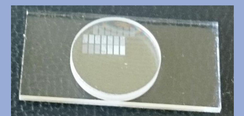
Spalt-überbrückendes Bonden von Kieselglas
